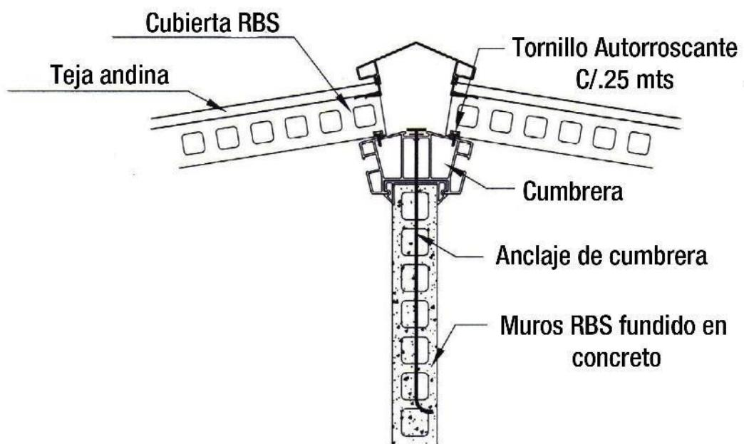
Detalle típico de fijación de cubierta
