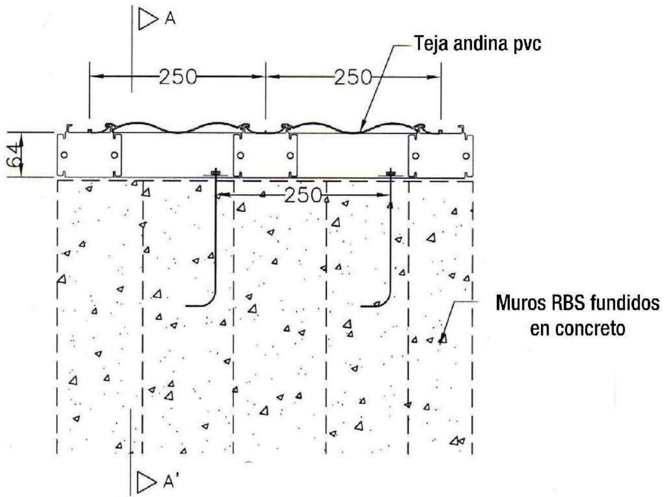
Detalle fijación de cubierta a muros orientados en el sentido perpendicular a la pendiente.
