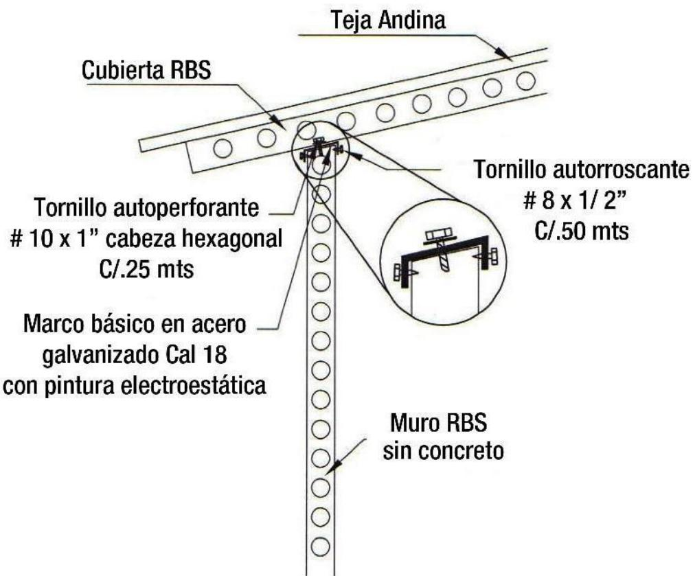
Detalle típico de fijación de cubierta
