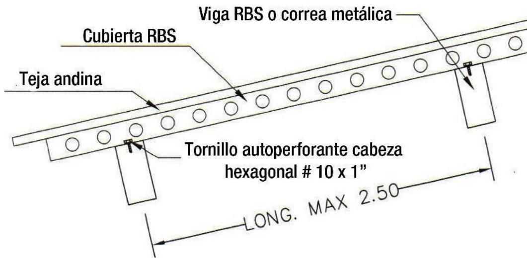
Detalle fijación de cubierta a vigas
