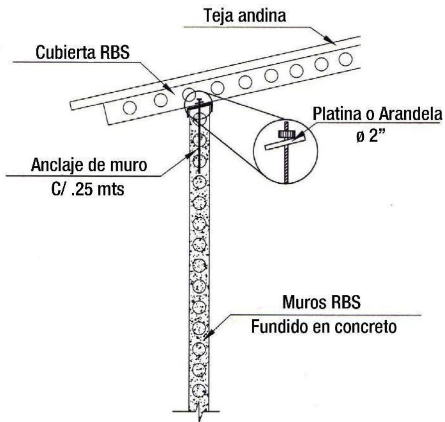
Corte A-A fijación de cubierta muros
