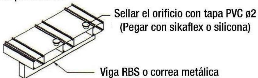
Procedimiento para la colocación de tornillos para viga RBS o correa metálica
